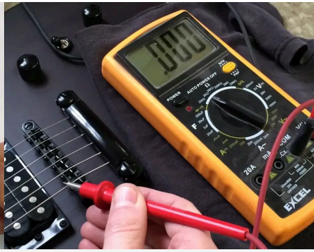
Problema de aterramento = teste de continuidade
