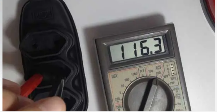
Tensão AC: Tomada 127V
