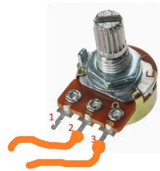
Ligação nos pinos 2 e 3, obtem-se um resistor que varia de forma decrescente ao giro do potenciômetro
