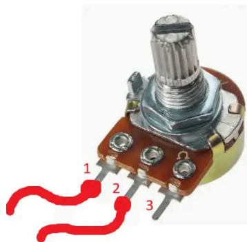
Ligação nos pinos 1 e 2, obtem-se um resistor que varia de forma crescente ao giro do potenciômetro
